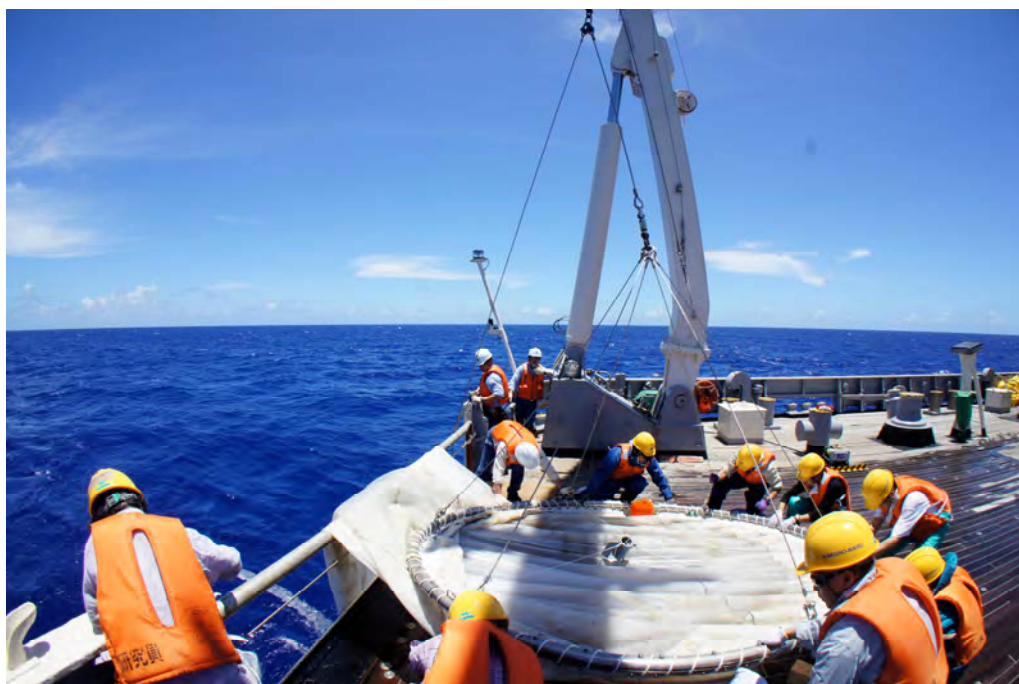
プランクトンネット「ビッグフィッシュ」の揚収作業
