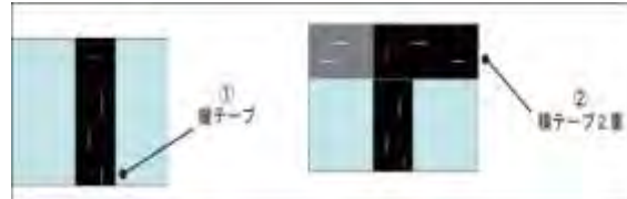
図5 テープの固定ガンタッカーで千鳥に止める
