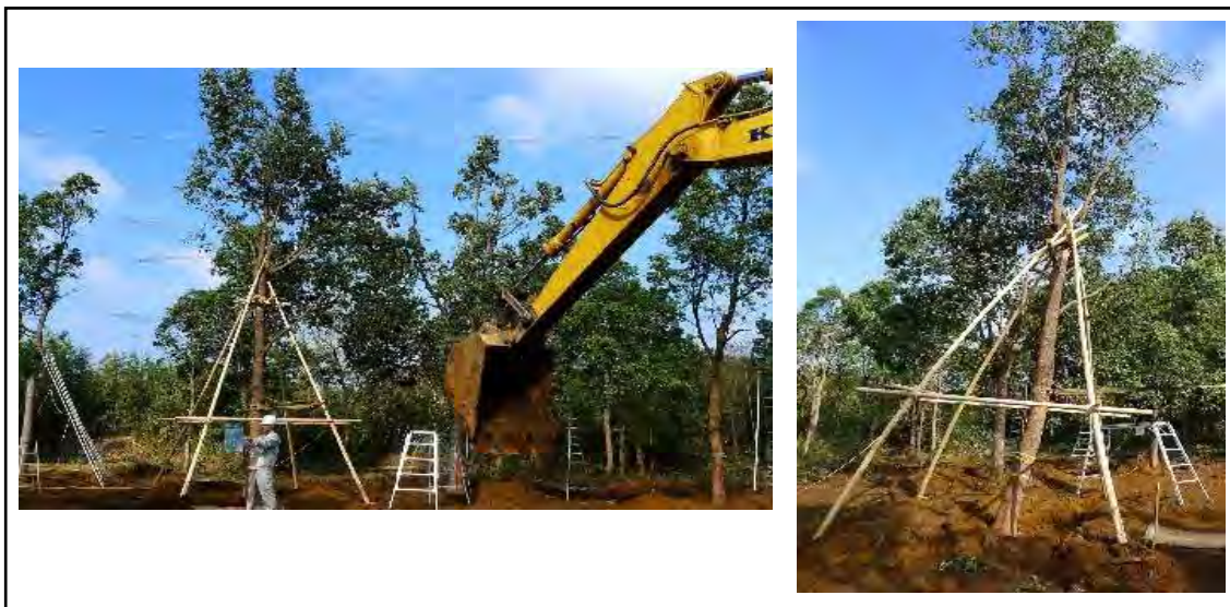
図-3 引倒しによる樹木の耐風性試験(やぐら支柱)
