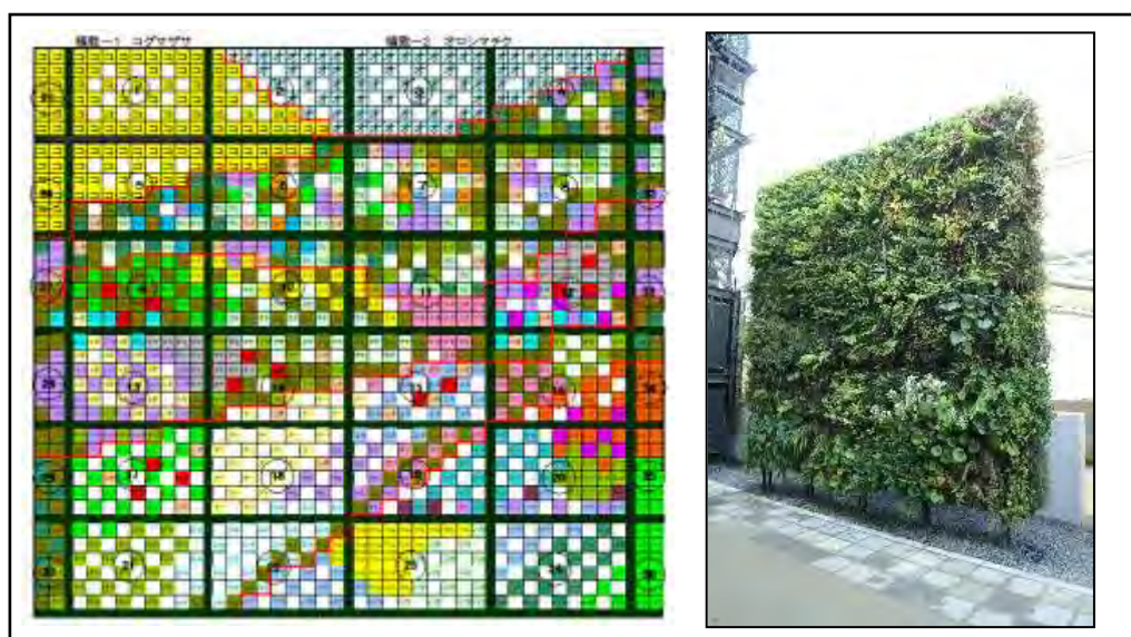
図-1 バイオラングの壁面緑化(設計図と完成写真)
