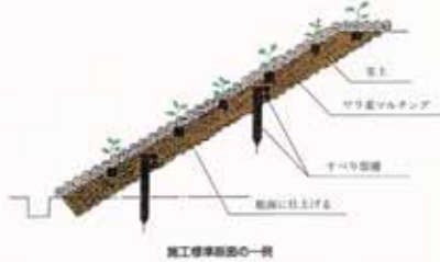
施工標準断面の一例
